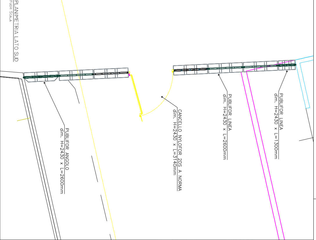
CANCELLO NYLOFOR 2DS A NORMA DIM. 2430X3140MM VISTA FRONTE FUORI SCALA
